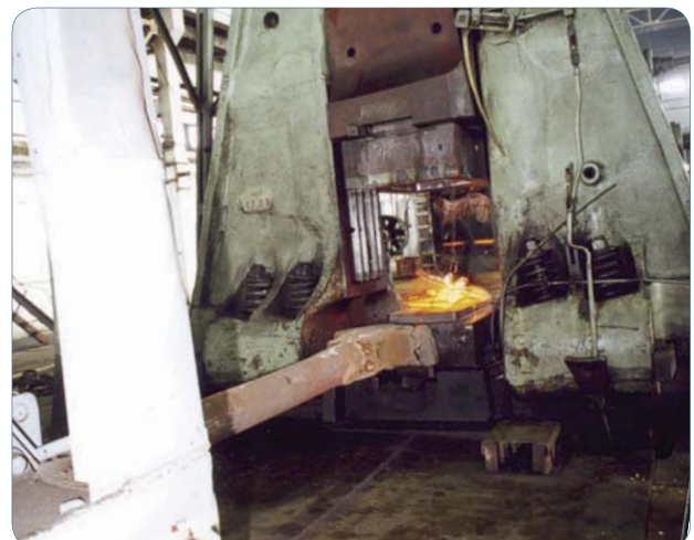
корпуса, фланцы (поковки в подкладных штампах)
